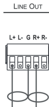
Рис. 6. Подключение к потребителю небалансного стерео аудиосигнала
